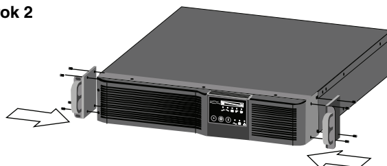
Rysunek 7 Modyfikacja zasilacza Liebert PSI XR na potrzeby instalacji w stojaku
