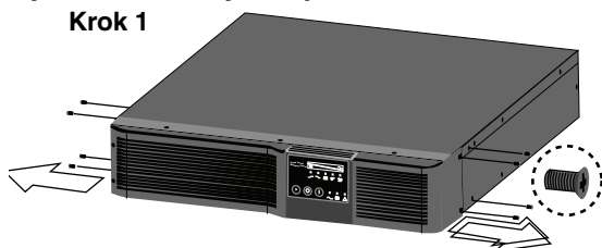
Rysunek 7 Modyfikacja zasilacza Liebert PSI XR na potrzeby instalacji w stojaku
